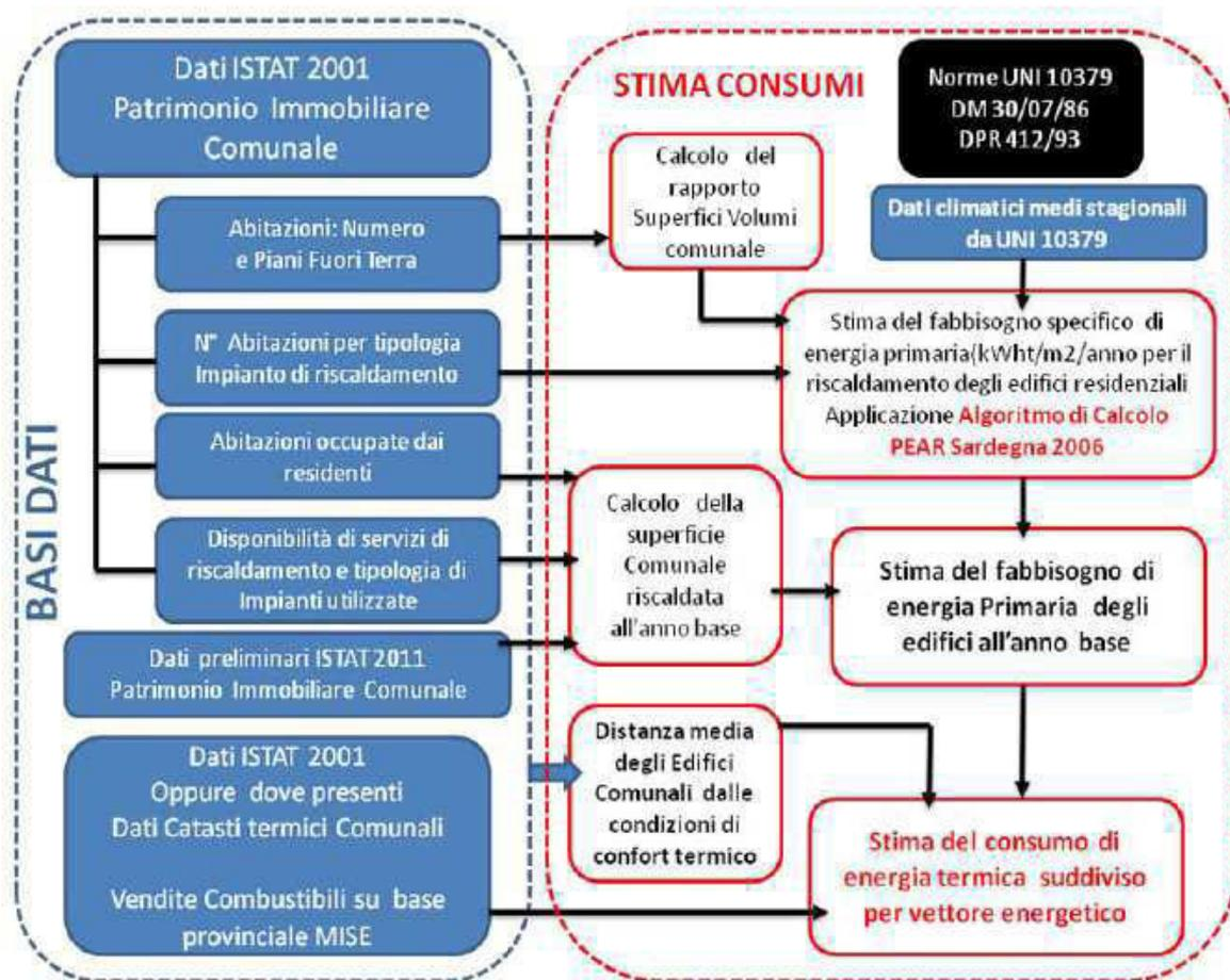
Figura 5. Schema a blocchi relativo del modello di calcolo utilizzato per la valutazione dei consumi termici nel comparto residenziale
